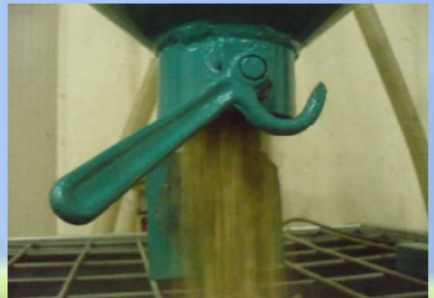
**Ciclone aspirapelletti, realizzato in acciaio al carbonio S235JR, ideale per aspirare il pellet da un silos esterno e scaricare direttamente sul serbatoio della vostra caldaia, adattabile a qualsiasi caldaia, viene appoggiato e fissato sopra alla botola di carico, la turbina crea una depressione in grado di aspirare fino a 8 Kg di pellet al minuto, con una prevalenza di 5 Mt ad una distanza totale di 20 Mt. Capacità del ciclone di circa 70 Kg di pellet di legno.**
